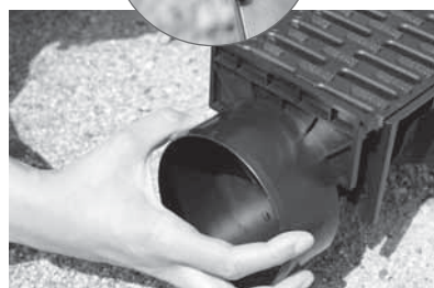
Clip A links en rechts met een mesje afsnijden. De twee B-clips in de kopse kant v/d goot vastklikken.
