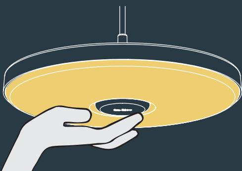
**NL** | Bij deze versie van de Disc wordt gebruik gemaakt van een geïntegreerde dimmer. Deze is geplaatst in het midden van het armatuur en is met nadering van de hand te bedienen.
