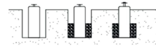
Zijaanzicht plaatsing betonpoer.
