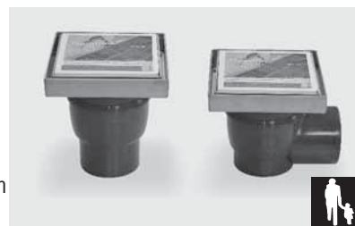
BlueStone vloerput met onder- en zijuitlaat. Inbouwdiepte 25 +2 tot 5 mm click
